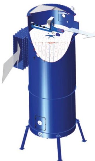
Blower-Filter mit Kratzboden und tangentialen Eintritt. Der Schnitt zeigt das PowerPulse®-Abreinigungssystem
