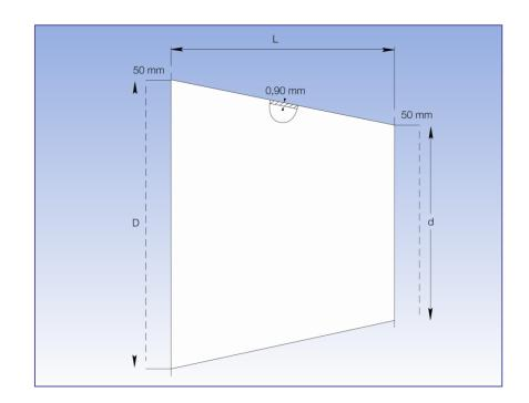
Bestimmung der Länge L des Konusstücks: Die Differenz zwischen dem großen und kleinen Durchmesser (D – d) des Konusstücks wird auf der senkrechten Achse (y) des Koordinatensystems markiert. Die waagerechte Linie von diesem Punkt bis zum Schnittpunkt verfolgen, und die Länge (L) kann in der X Achse abgelesen werden.
