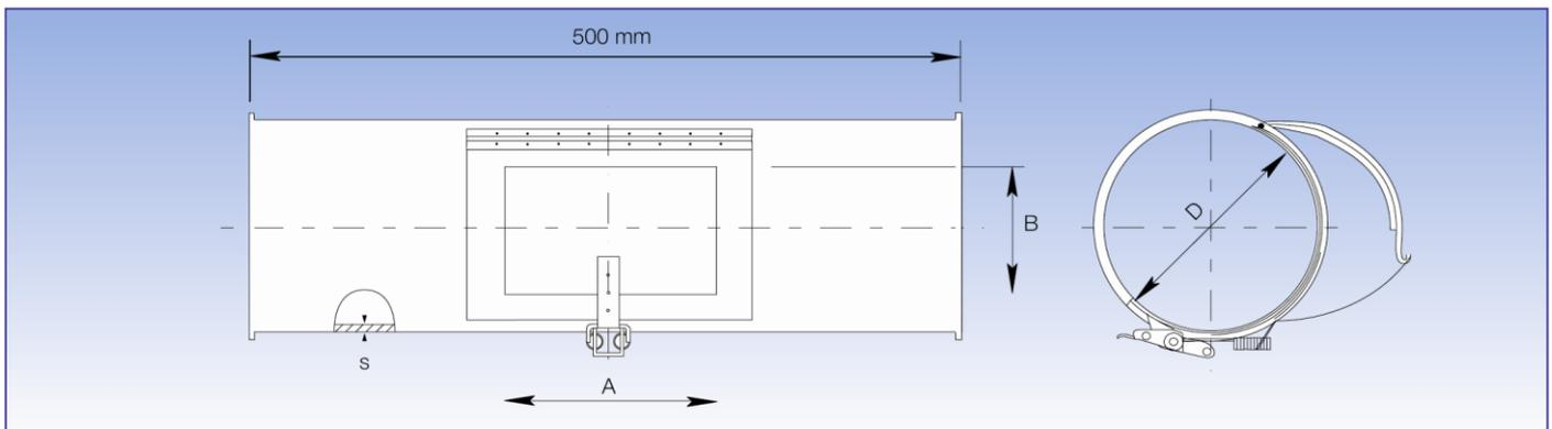
Die Inspektionsklappen sind auch ohne Rohr für alle Standard-Rohre verzinkt, für die entsprechenden Durchmesser lieferbar.
