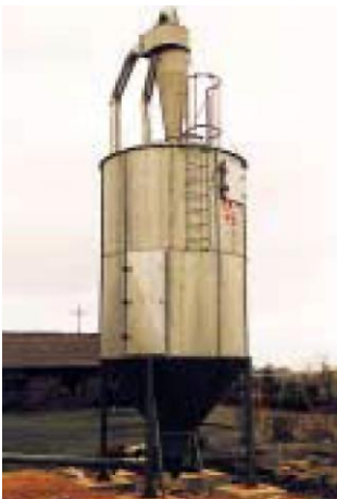
Silo mit Austragung und Schneckenförderer
